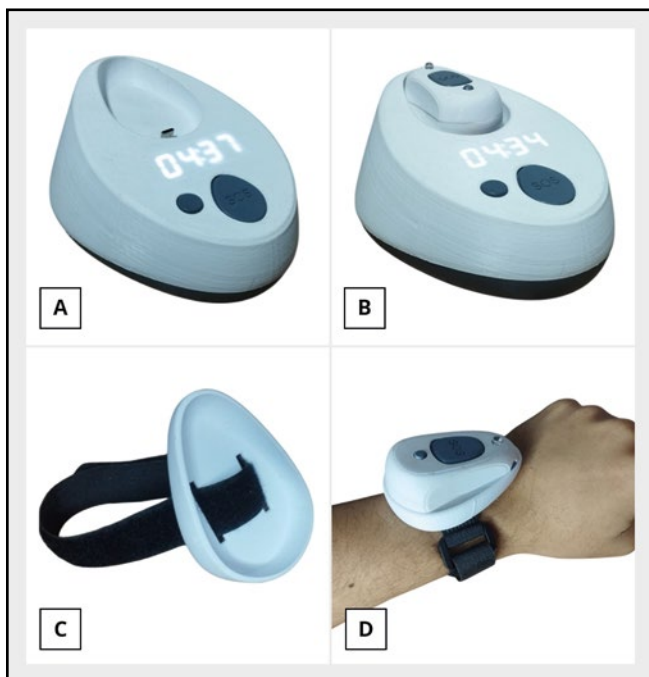
Figura 1. (A) Prototipo de base de carga; (B) dispositivo portátil en base de carga; (C) accesorio con correa ajustable; (D) dispositivo portátil en uso.
